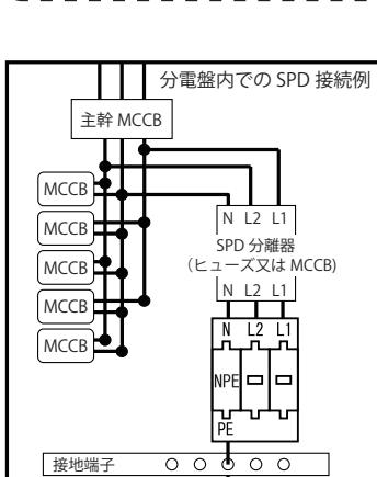
接地線が接続されていない場合には機器の保護が出来ません。SPD の接地線は、機器の接地線が接続されている盤の盤内接地端子に接続して下さい。
