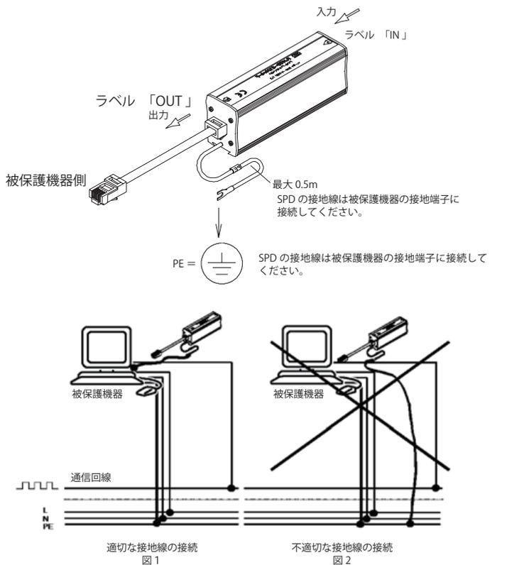
SPD の接地線は図 1 のように被保護機器へ接続してください。図 2 のように結線した場合は、接地線インピーダンスにより電圧降下が発生し、SPD の防護効果が減少します。
